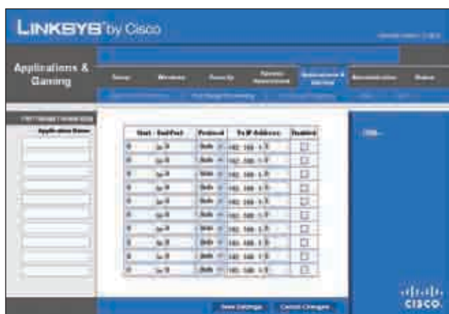
Applications and Gaming > Port Range Forwarding (Aplicativos e jogos > Encaminhamento de intervalo de portas)
